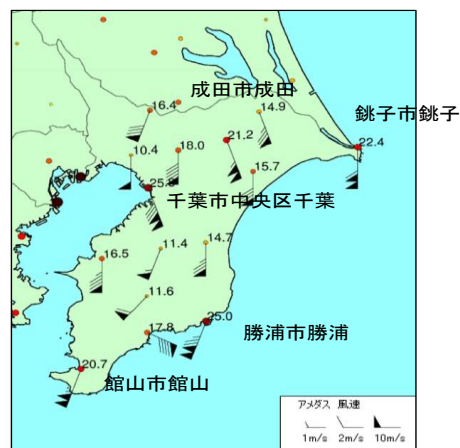
図8 千葉県内各地の最大風速と風向 数値は10月12日の最大風速、地名は、日最大風速20m/S以上の非常に強い風を観測した地点を示す。台風第15号を超える南寄りの風には達しなかった。 （銚子地方気象台ホームページより入手した資料に加工）
